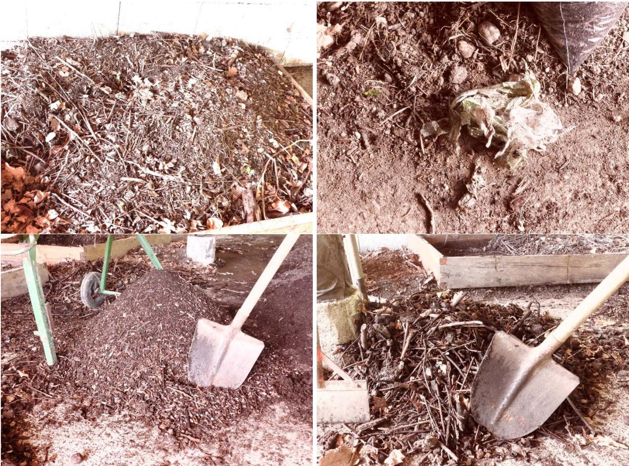
Abbildung 14: Absiebung des Rottegutes von Variante 2 mittels 10 mm Trommelsiebes am 19.5.2022 (nach einer Rottedauer von 82 Wochen). Bild oben links: Miete vor dem Absieben, oben rechts: Reste der „Biosacker!“ in der Fraktion >10 mm (diese wurden durch Windverfrachtung eingebracht!). Bild unten links Siebdurchgang (Fraktion <10 mm), rechts Siebüberlauf (Fraktion > 10 mm)
