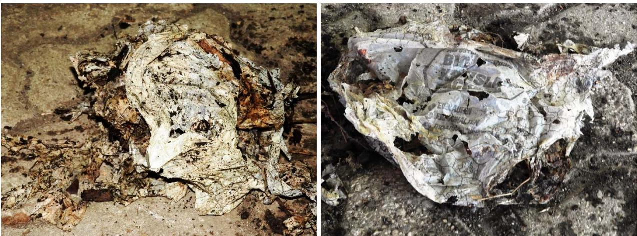
Abbildung 17: Absiebung des Rottegutes von Variante 5 mittels 10 mm Trommelsiebes am 19.5.2022 (nach einer Rottedauer von 82 Wochen). Reste der „Biosackerl“ in der Fraktion >10 mm.
