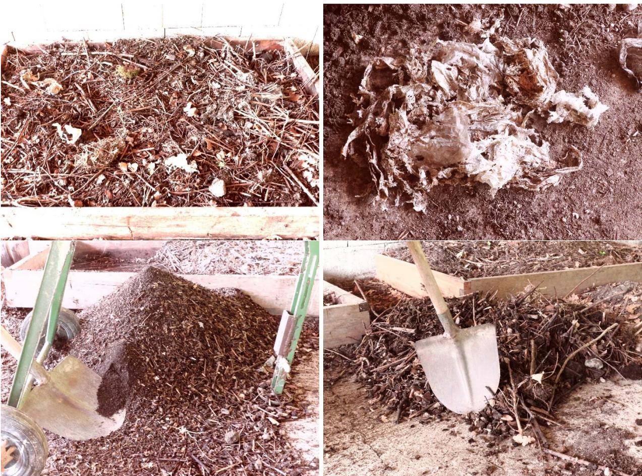
Abbildung 13: Absiebung des Rottegutes von Variante 1 mittels 10 mm Trommelsiebes am 19.5.2022 (nach einer Rottedauer von 82 Wochen). Bild oben links: Miete vor dem Absieben, oben rechts: Reste der „Biosackerl“ in der Fraktion >10 mm. Bild unten links Siebdurchgang (Fraktion <10 mm), rechts Siebüberlauf (Fraktion >10 mm)
