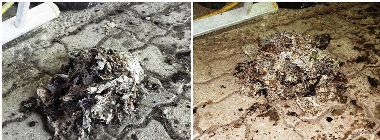
Abbildung 18: Absiebung des Rottegutes von Variante 6 (links) und 7 (rechts) mittels 10 mm Trommelsiebes am 19.5.2022 (nach einer Rottedauer von 82 Wochen). Reste der „Biosackerl“ in der Fraktion > 10 mm.
