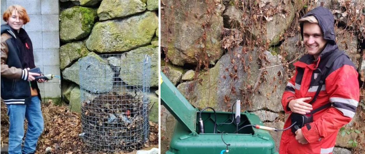
Abbildung 2: Mietenbetreuung durch Schüler\*innen – links Temperaturmessung beim Gitterkomposter (Foto Manuel Eisschill) und rechts Messung von Temperatur und Porenluftzusammensetzung beim Thermokomposter (Foto Shania Reichhard)
