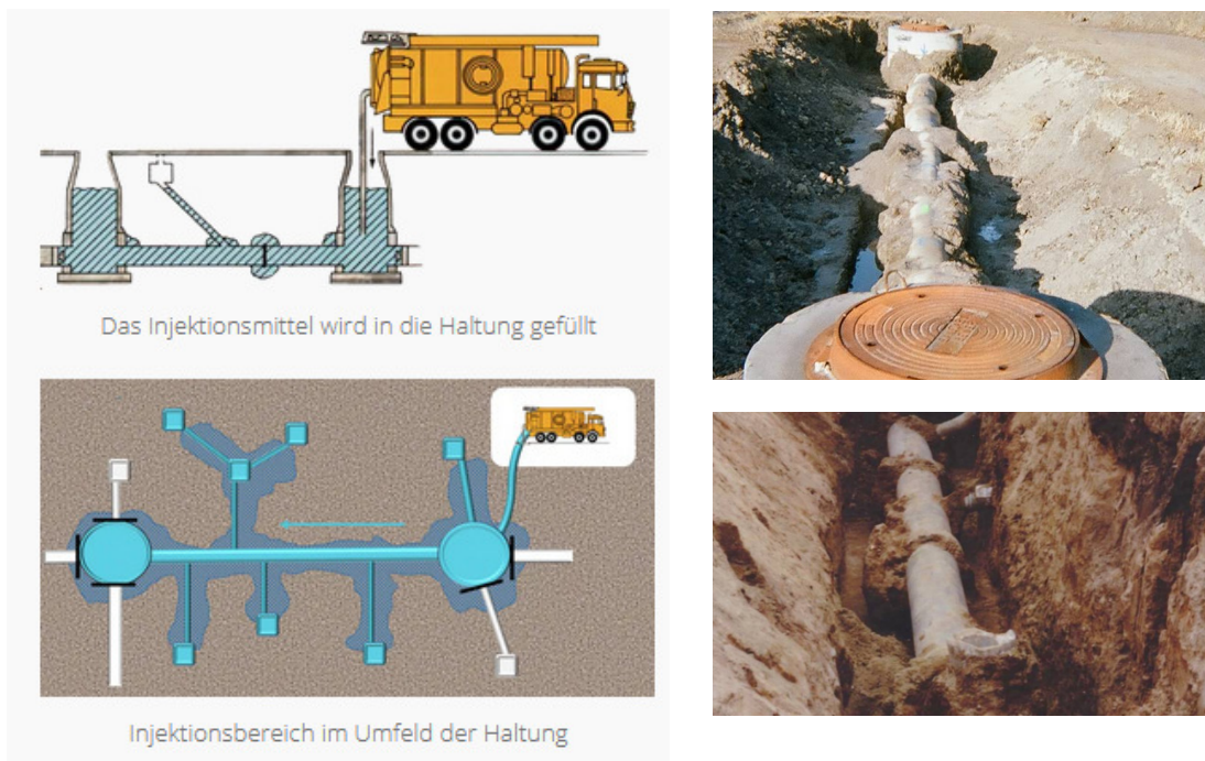
Abbildung 3: Verfahrensablauf Flutung und frei gelegte Leitungsabschnitte (Quelle der Abbildungen: SANIPOR®)
